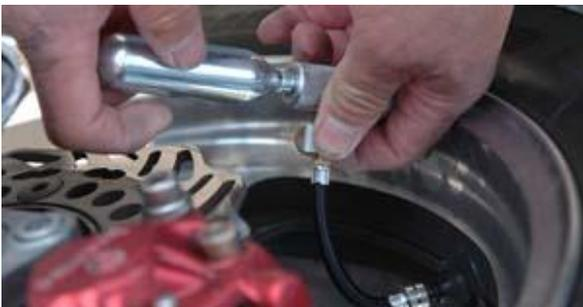
※ホイールの形状により金属バルブが取り付けにくい場合は画像のように付属のフレキシブルバルブをバイパスしてご利用ください。
